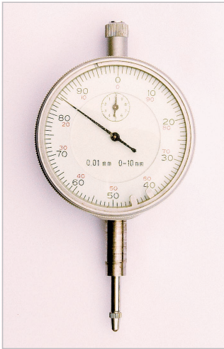
Eine Messuhr ist günstig (20 bis 100 €) und eine unverzichtbare Hilfe beim Fokussieren.
