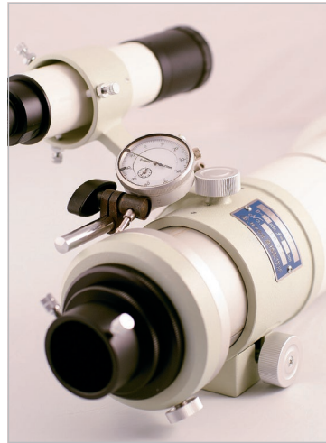
Links eine auf einem Refraktor installierte Messuhr. Ein kleines Stück Aluminium unter dem Sucherfernrohr stützt eine Achse ab, die die Messuhr über ein kleines Kugelgelenk hält. Der Messtaster drückt auf das bewegliche Teil des Okularhalters. Rechts ist die Messuhr auf einem Newton-Teleskop mit einem kleinen Gelenkarm befestigt, wobei der Messtaster gegen die Kamera drückt.
