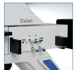
● Détail de l'éclairage réfléchi
