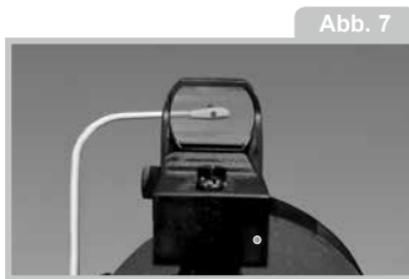
2. Verwenden Sie die beiden Einstellknöpfe der Rück- und auf der Vorderseite des Fernrohrs, um den roten Punkt nach oben/unten/links/ zu bewegen. Schauen Sie durch den Sucher und nehmen Sie die Einstellungen so vor, dass sich der rote Punkt genau mit dem gleichen
