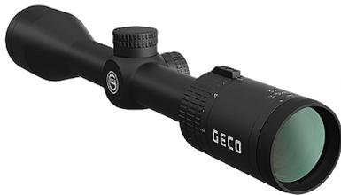
Das GECO 3-9x42 Zielfernrohr ist ein seit Jahrzehnten bewährter Allrounder, der besonders kompakt und führungstauglich ist - er eignet sich optimal für Pirsch und Ansitz. Dank beleuchtetem Absehen in der 2. Bildebene und größerem Objektivdurchmesser von 42 mm ist die Optik auch für schlechte Lichtverhältnisse geeignet.
