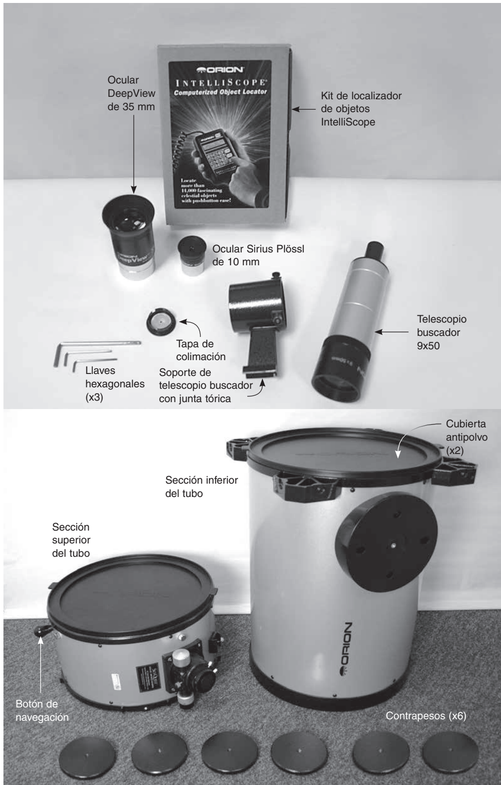
Figura 2. Piezas de la caja que contiene el tubo óptico y los accesorios.
