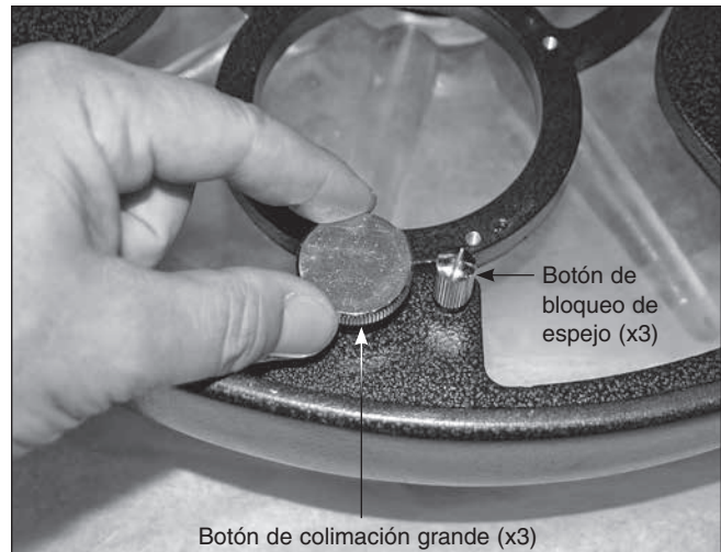
Figura 40. La inclinación del espejo primario se ajusta girando uno o varios de los tres botones de colimación grandes.
