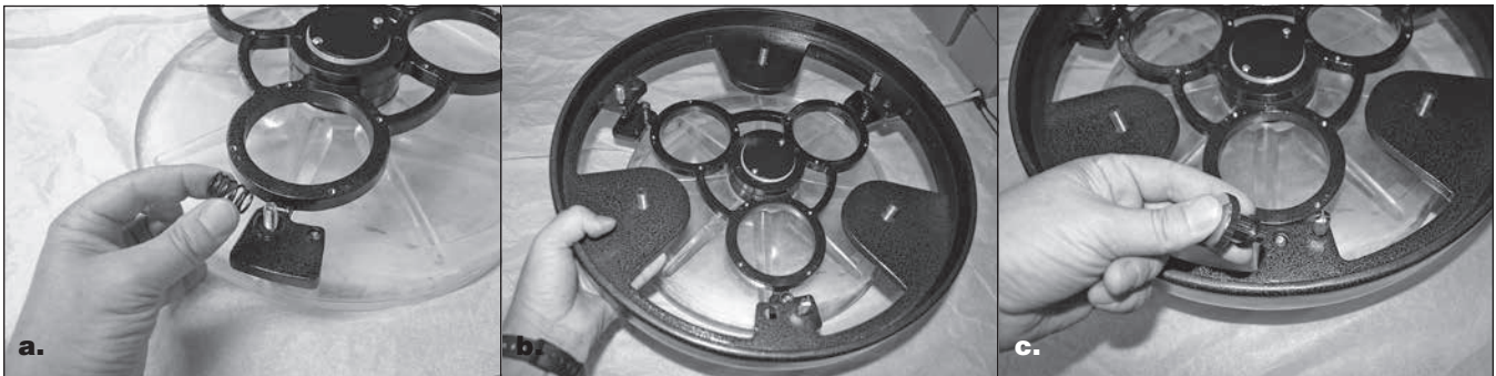
Figura 20. (a) Coloque los tres resortes en los ejes roscados expuestos de la celda del espejo. (b) Baje el anillo del extremo posterior en la celda del espejo de manera que los ejes roscados pasen a través del anillo del extremo y el anillo del extremo descansa sobre los resortes. (c) Enrosque los botones de colimación, con las arandelas de nylon acopladas, a través del anillo del extremo posterior y en los ejes roscados. Asegúrese de que los botones tienen por lo menos tres vueltas completas de engranaje en los ejes.
