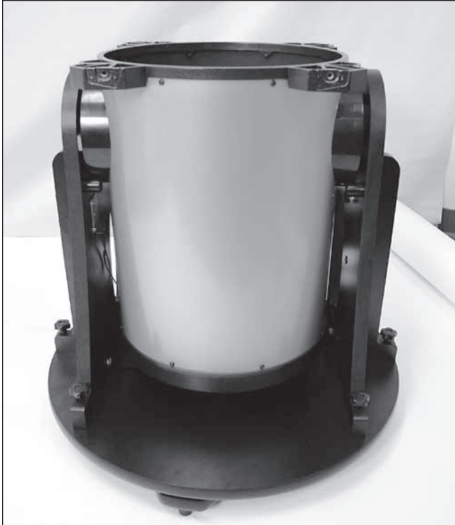
Figura 24. En lugar de montar el tubo óptico entero y luego izarlo sobre la base, puede resultar más cómodo montar primero la sección inferior del tubo sobre la base y, a continuación, instalar los tubos de celosía y sección superior del tubo.
