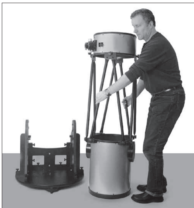
Figura 28. Levante el tubo óptico sujetando dos polos de celosía y bájelo cuidadosamente de modo que los ejes de rodamiento de altura queden sobre los cilindros del rodamiento de altura en los paneles laterales.
