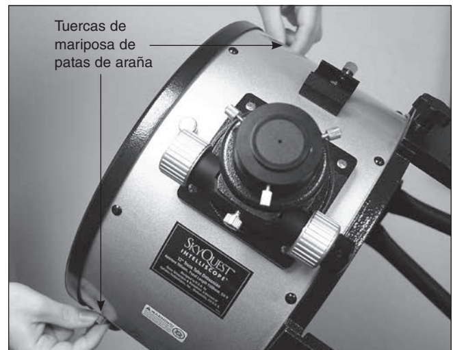
Figura 39. Para centrar el espejo secundario radialmente en el tubo del enfocador, ajuste las dos tuercas de mariposa moleteadas de las patas de araña perpendiculares al enfocador.
