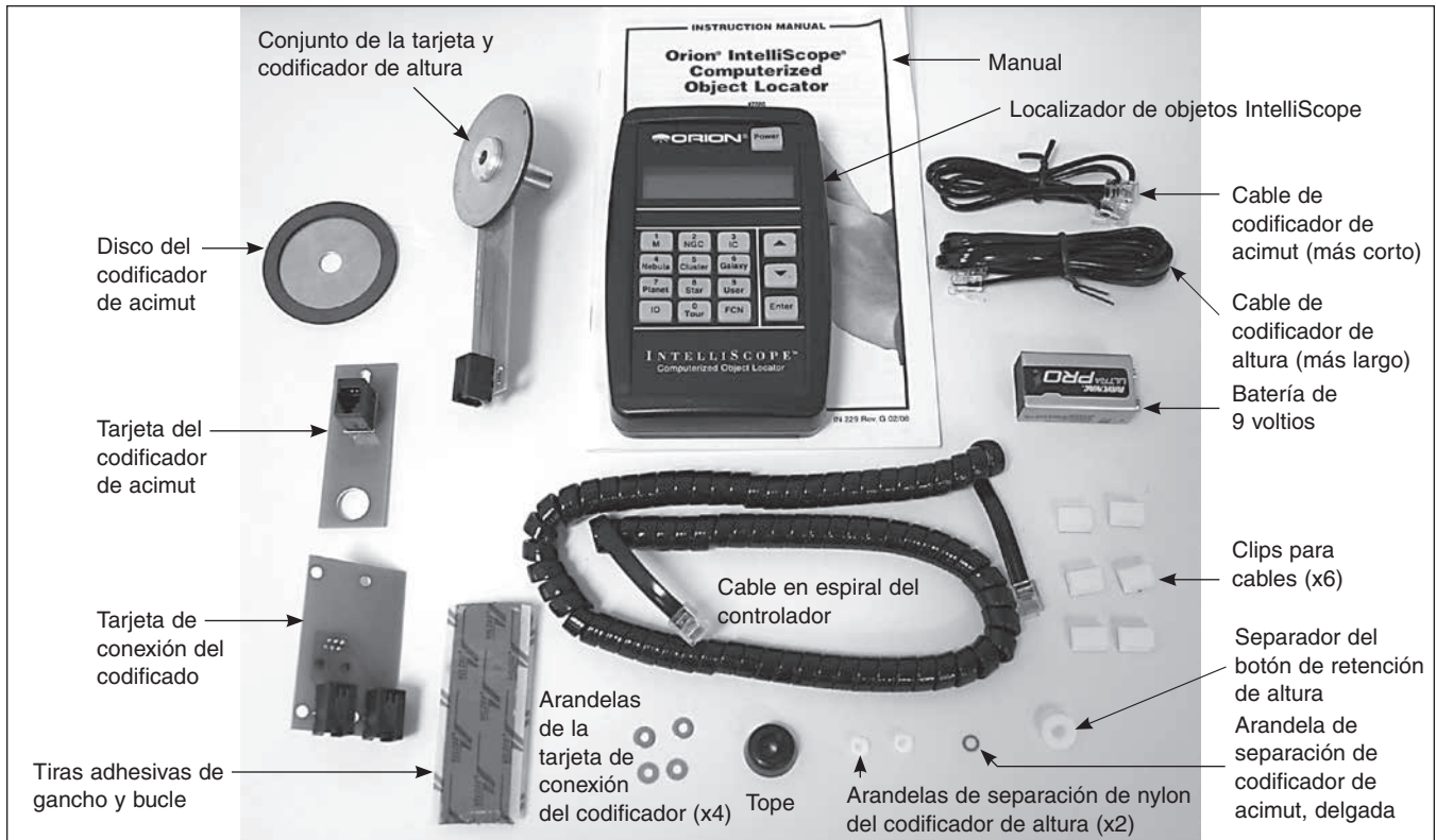
Figura 3. Piezas de la caja del localizador de objetos IntelliScope.
