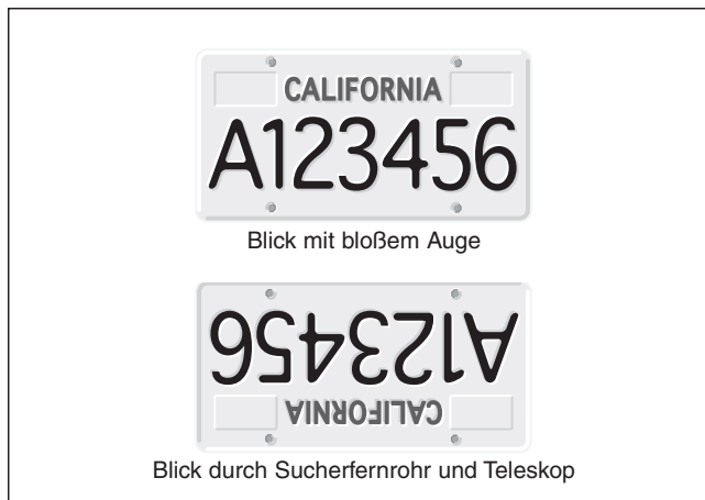
Abbildung 44. Der Blick durch ein gerades Sucherfernrohr / Spiegelteleskop ist um 180° gedreht.
