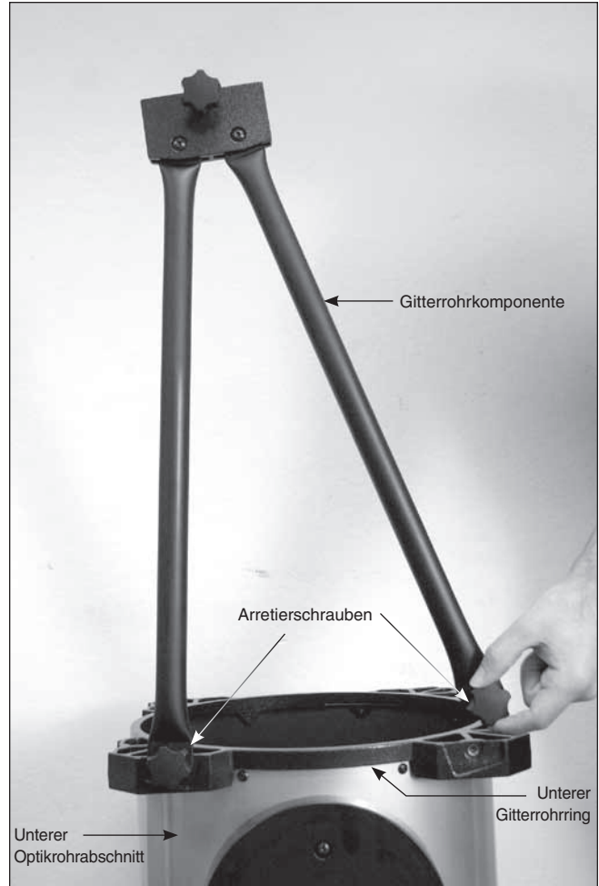
Abbildung 23. Die Arretierschrauben an den Stangenenden werden in die Bohrungen am unteren Gitterrohrring des unteren Optiktrohrabschnitts geschraubt.
