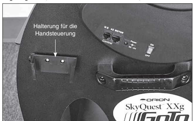
Abbildung 12. Suchen Sie die beiden vorgebohrten Löcher und befestigen Sie die Halterung für die Handsteuerung - ziehen Sie die Schrauben aber nicht zu fest!
