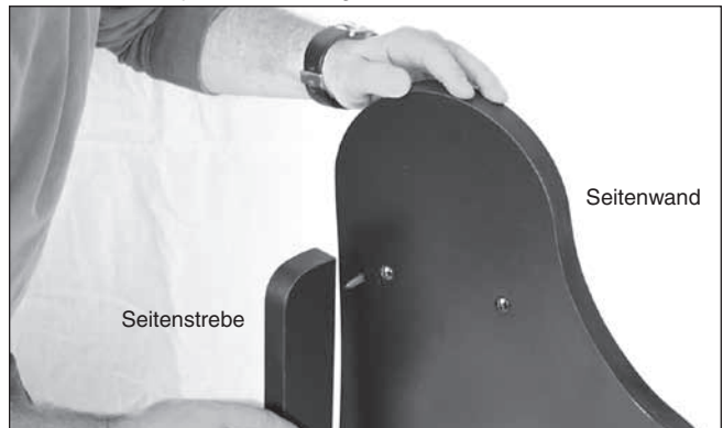
Abbildung 7. Bringen Sie an der Außenseite jeder Seitenwand mit Hilfe von drei Holzschrauben für die Montage der Basis und dem 4-mm-Inbusschlüssel eine Seitenstrebe an.
