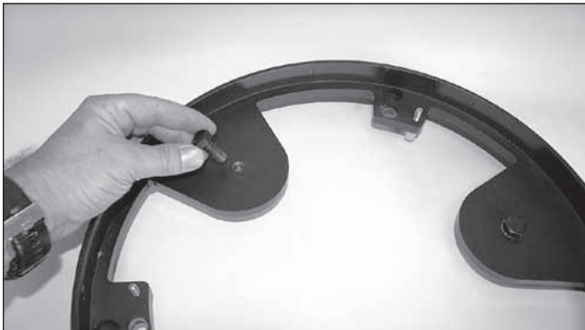
Abbildung 15. Schrauben Sie die drei Sechskant-Befestigungsschrauben für die Gegengewichte (nur XX14g und XX16g) wie in der Abbildung gezeigt in die Bohrungen an den Gegengewicht-Halteplatten. Ziehen Sie die Schrauben mit einem verstellbaren Rollgabelschlüssel oder einem 16-mm-Schraubenschlüssel fest.
