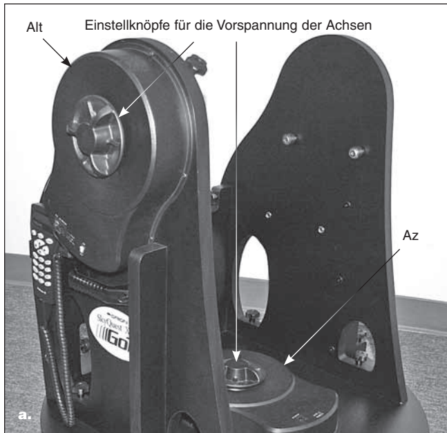
Abbildung 34. a) Die bei XXg-Dobson-Teleskopen neu gestalteten Gehäuse für den Höhenmotor (Alt) und den Azimut-Motor (Az) sowie für die entsprechenden Encoder verfügen über große Drehknöpfe zur manuellen Einstellung der Vorspannung auf den Bewegungsachsen. b) Drehen Sie den Einstellknopf, um über die Reibung an den Kupplungspunkten die Vorspannung der Achsen beim Schwenken des Teleskops einzustellen.
