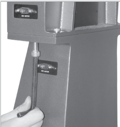
Fig. 53 : Serrez les bras de la fourche à l'aide de la clé à six pans fournie.
