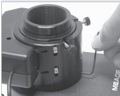
Fig. 60 : Serrez les trois vis à tête hexagonale du système de mise au point.
