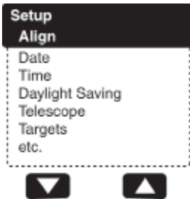
Fig. 17 : les options du menu s'affichent sur la deuxième ligne. Utiliser les touches de défilement pour monter ou descendre dans la liste d'options. Appuyer sur ENTER pour sélectionner une option.
