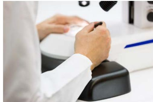
Die spiegelbasierte Durchlichteinheit von Stativ K LAB mit dem kipp- und verschiebbaren Spiegel bietet Hellfeld, einseitiges Dunkelfeld und Schräglicht und wahlweise auch qualitativen Polarisationskontrast. Nutzen Sie zusätzlich die ergonomische Handauflage, wenn Sie länger damit arbeiten, und die doppelarmige LED-Beleuchtung mit Schwanen-hals für Auflicht.
