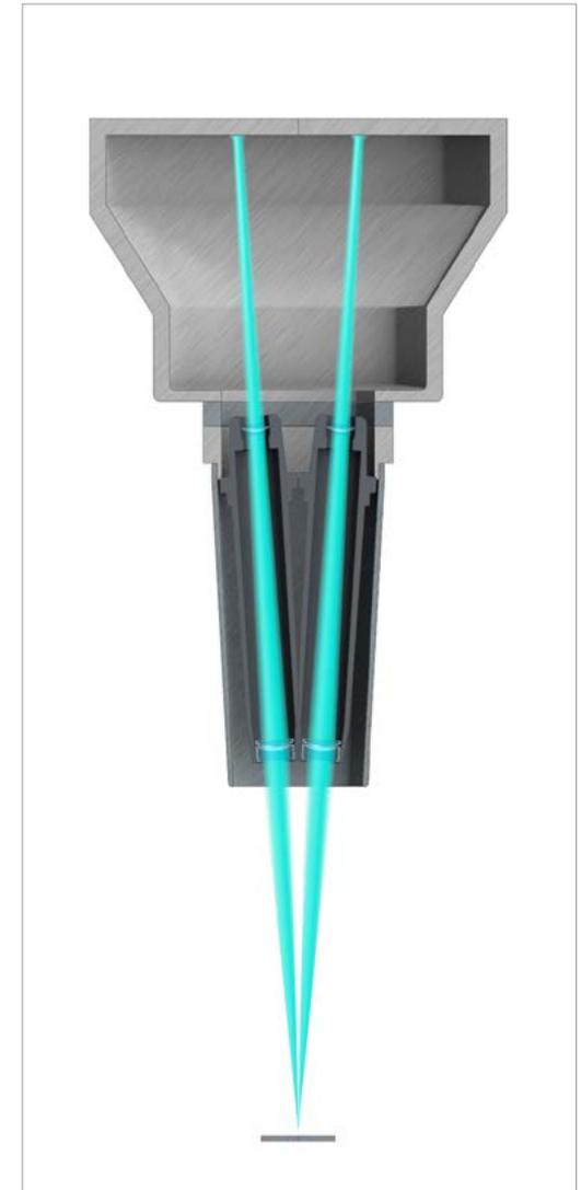
Strahlengang eines Greenough-Stereomikroskops
