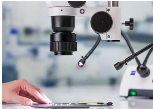
*Der horizontale Kugellagerarm des Doppelarmauslegerstativs SDA ermöglicht einen großen Verfahrbereich und problemlose Bewegungen. Fokussieren Sie Ihre Probe, indem Sie die variable Frontlinse drehen, anstatt den Fokustriebes Ihres Stemi-Trägers zu verwenden.*
