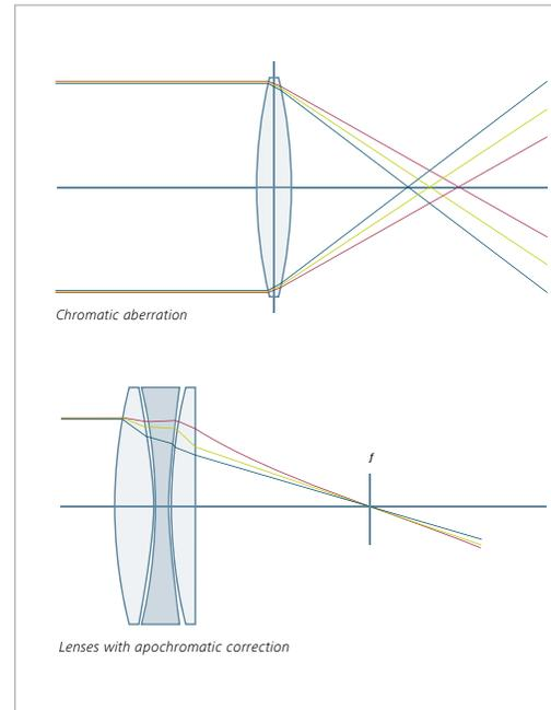
korrigieren den Linsenfehler für drei Farben (Rot, Grün und Blau) des sichtbaren Lichtspektrums, indem sie die drei Wellenlängen auf dieselbe Ebene fokussieren. Apochromatische Objektive erzeugen schärfere und brillantere Bilder, weshalb sie vorzuziehen sind, wenn für Evaluierungen und Dokumentationen eine hohe Bildqualität erforderlich ist.
