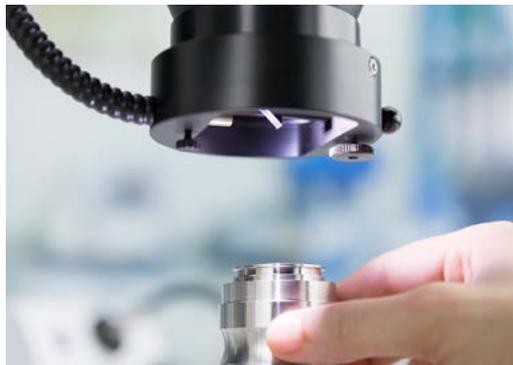
*Untersuchen Sie Bohrungen, Gewinde und Vertiefungen mit dem Vertikalilluminator S. Dessen 45°-Spiegel kann zur Vermeidung einer Vignettierung angepasst werden.*
